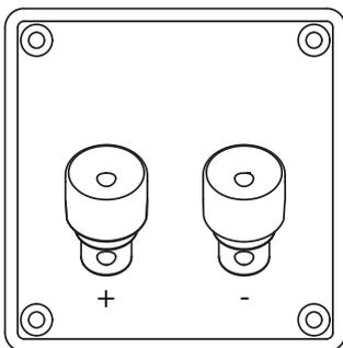
При использовании АС в системах домашнего кинотеатра пассивный сабвуфер следует подключать к свободным выходным акустическим клеммам усилителя.
